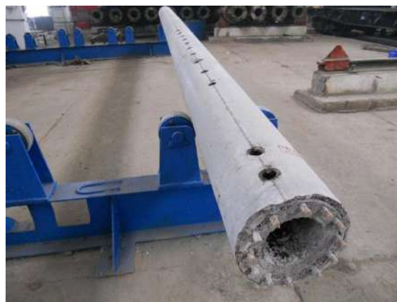
Рисунок 2 - Стойка опоры контактной сети с композитным армированием
