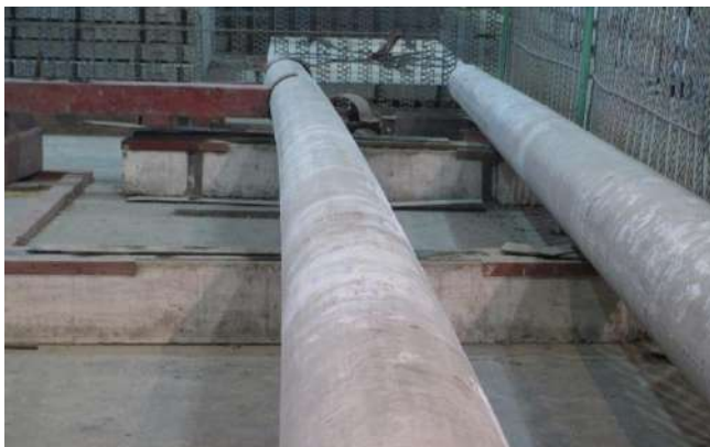
Рисунок 6 - Стойка опоры № 4 на испытательном стенде перед разрушением опоры
